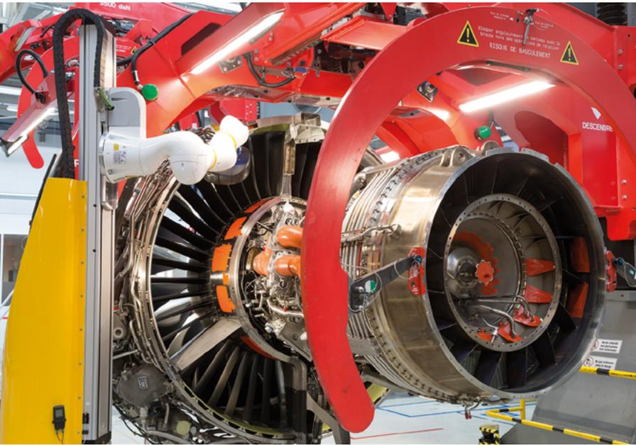
**CI-CONTRE ET CI-DESSOUS :** Visiter Villaroche, c'est plonger dans l'usine du futur, avec notamment des technologies de pointe comme la cobotique, permettant d'associer en temps réel les capacités d'un robot (force, précision, répétition) avec les compétences spécifiques d'un être humain (savoir-faire, analyse, décision).
