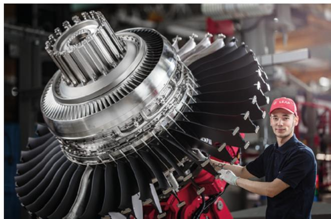
**CI-CONTRE ET CI-DESSOUS :** Au cœur du bâtiment 35, un hall 4.0 de 35 000 m<sup>2</sup>, on trouve les lignes d'assemblage pulsées LEAP, conçues avec une grande ergonomie des postes de travail pour les équipes salariées. Les mouvements des moteurs sont gérés via des écrans tactiles. La manutention aérienne par balancelles permet la rotation des moteurs sur leur axe horizontal afin de supprimer le travail en hauteur.
